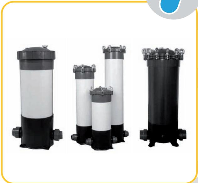
I filtri a cartuccia Upvc sono adatti a processi di filtrazioni di fluidi corrosivi con pressioni a 4 o 7 Bar (modello hp) ad una temperatura massima di 60°(combinazione di elemento filtrante e materiale delle guarnizioni).
