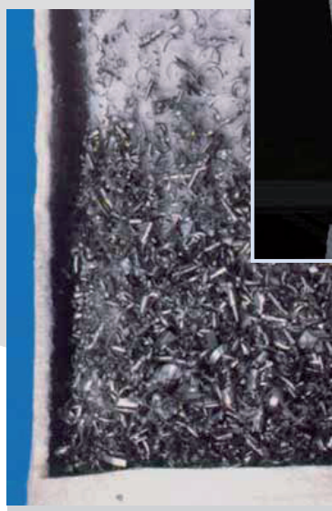
Parti metalliche raccolte durante la filtrazione in un impianto lavapezzi
