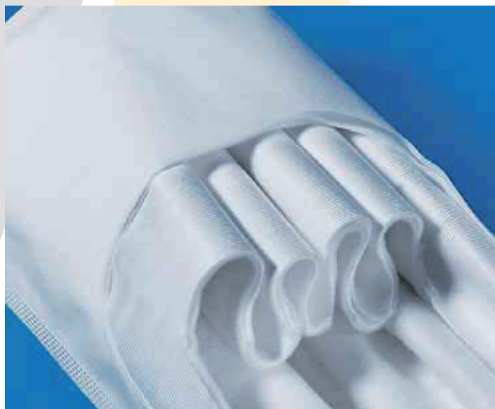
L'elevata superficie di prefiltrazione (circa 3m 2 ) permette la rimozione del particolato e dei gel prima di arrivare agli strati di filtrazione finale.
