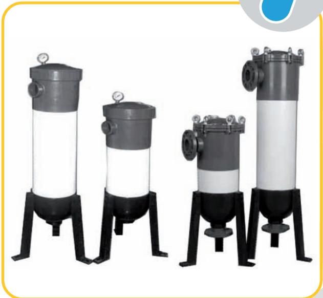
I filtri a sacco Upvc sono adatti a processi di filtrazioni di fluidi corrosivi con pressioni a 4 o 7 Bar (modello hp) ad una temperatura massima di 60°(combinazione di elemento filtrante e materiale delle guarnizioni).
